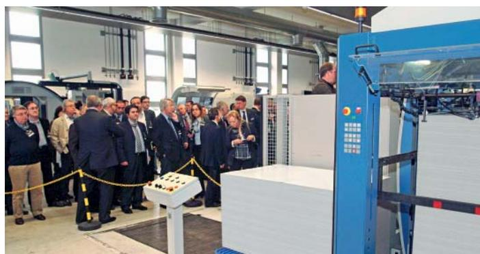
与会者对大幅面印刷机在最大速度为15000张/小时下进行不停机换纸堆也留下了深刻的印象
