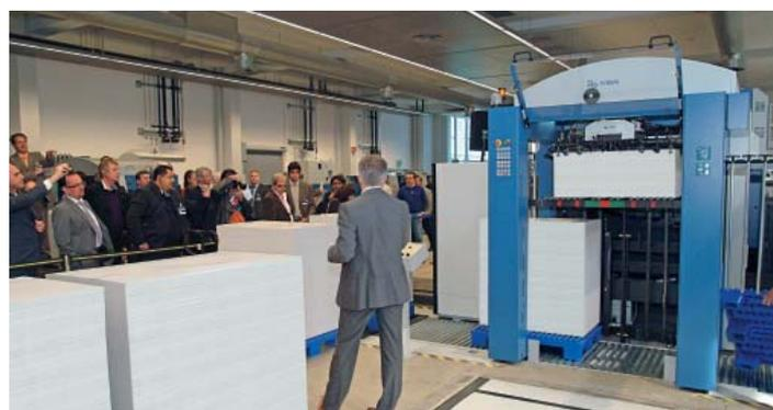
在利必达106胶印机上印刷双涂层纸板在18000张/小时下进行不停机换纸堆
