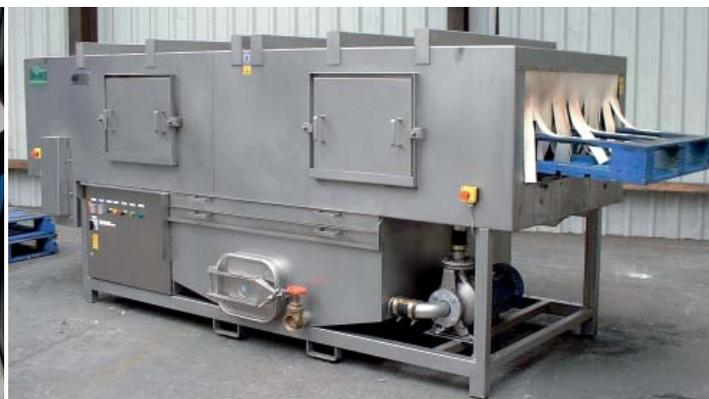
卫生要求同样适用于纸台，对系统的选择也很多：上面的照片显示的是Limex清洗设备，也可以将其用于清洗木制纸台，右图是一家食品加工厂中将舒乐阿卡合成材料纸台放在Kettner输送带上的情况
