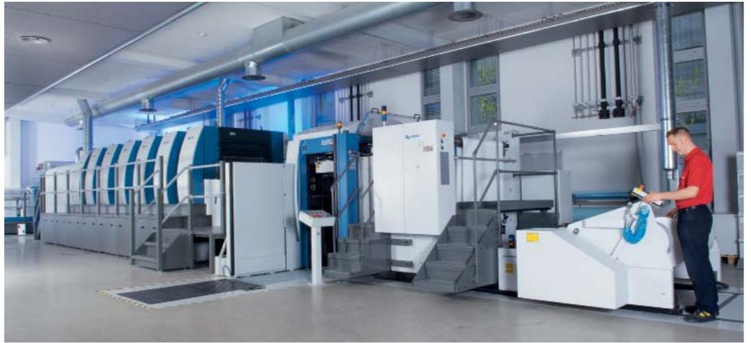
在拉德博伊尔客户服务中心的展厅中利必达106胶印机加配卷筒纸输纸装置进行印刷生产
